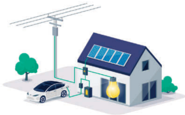
Rysunek 4: Idea zastosowania pojazdu elektrycznego jako magazynu energii
